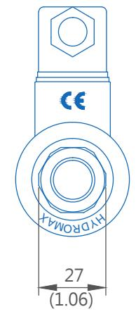
**Dimension** 21-N-P外型尺寸圖 Millimeters/(inch)
